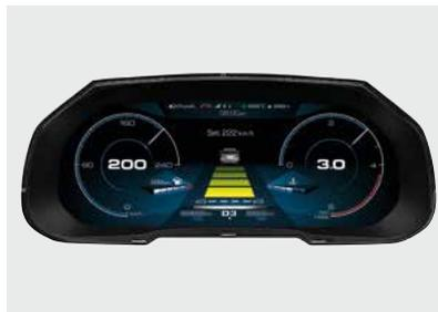
Mit seinem 12,3-Zoll-TFT-Farbdisplay unterstützt das digitale Kombiinstrument flexibel personalisierbare Anzeigestile wie klassisch, sportlich oder modern. Dabei kommen Konzeption, Entwicklung und Validierung der grafischen Benutzeroberfläche (GUI) aus einer Hand – alles „Made by Bosch“. Die digitalen Warnleuchten erfüllen alle ASIL-B-Anforderungen und bieten damit ein hohes Maß an Sicherheit.
